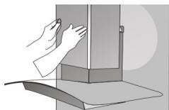
1. Вставьте внутреннюю часть телескопического короба во внешнюю. Закрепите внешнюю часть короба к корпусу вытяжки.
