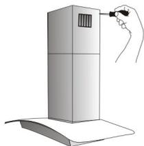
2. Выдвините внутреннюю часть короба и закрепите ее винтами на крепежной скобе.
