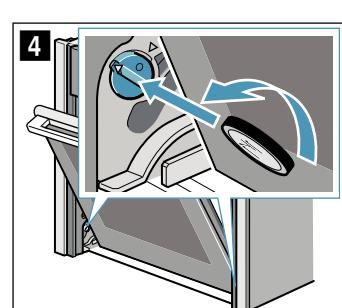
3. Выверните с помощью монеты оба фиксатора дверцы (рис. 4).
